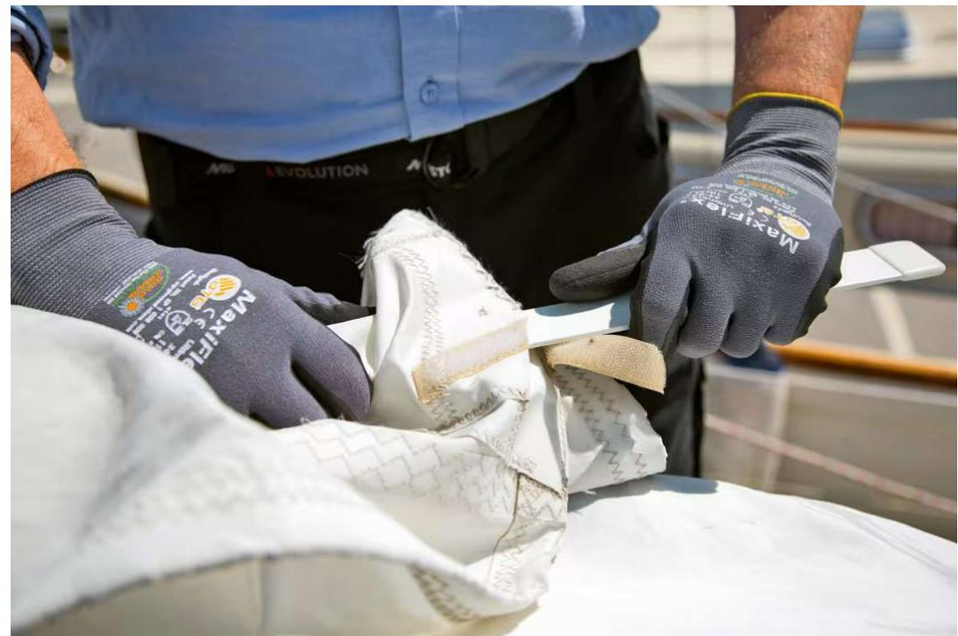
Sur les vieilles lattes de voile, les brins de fibre de verre se détachent et peuvent se détacher, se transformant en éclats pointus comme des aiguilles. Le carbone cassé est également extrêmement pointu et tranchant. Lors de travaux sur de telles pièces, porter des gants avec les bouts des doigts fermés.
