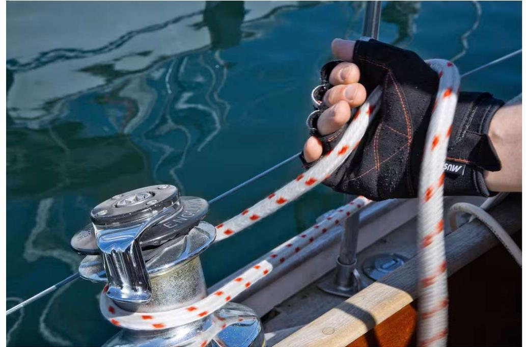
Le port de gants est la protection la plus simple. Sinon, un bon maniement aide. Un nombre suffisant de tours sur le winch minimise la traction de l'écoute de génois. Une drisse devrait également être occupée sur un winch avant d'ouvrir une pince à levier. Il en va de même pour l'écoute de gennaker ou de spinnaker avant que la voile ne s'ouvre. Et si l'écoute se met à vibrer, il faut vite la relâcher, surtout en cas de mer agitée.
